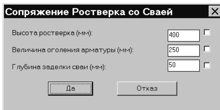
Рис. 3-31 Сопряжение ростверка со свайей.
